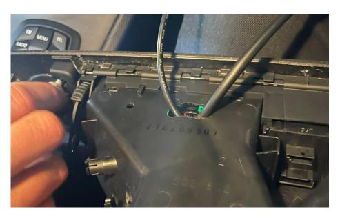
Die Anschluss-Kabel am Display einstecken (Plug A und Plug B), sowie das USB-Kabel und mit der Durchzughilfe (Kabel) in Richtung rechtem Fußraum durchfädeln.
