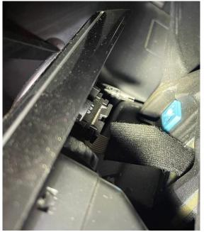
Nun kann die gesamte Blende entnommen und für den Einbau des Displays vorbereitet werden. Dazu müssen die Ausströmer der Lüftung von der vorderen Blende trennt werden. Nach dem Demontieren der Hebelmechanik zur Verstellung der Klappen (gelb) müssen die beiden Muttern (rot) entfernt und die Blende noch rundum entclipst (blau) werden.
