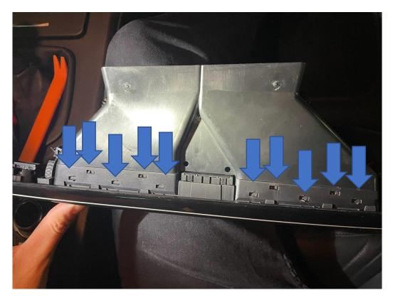
Jetzt können die Lamellen und das zweite Innenteil aus dem Kanal entfernt werden.
