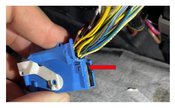
Wir benötigen Pin 1 (blau/rot – Can High) und Pin 2 (Rot – Can Low). Am unteren Pfeil ist der Pin eingehakt. Die Verankerung drücken und vorsichtig am Kabel den Pin herausziehen. Manchmal bleibt der Pin am zweiten Pfeil hängen – dort dann auch nochmal entriegeln:
