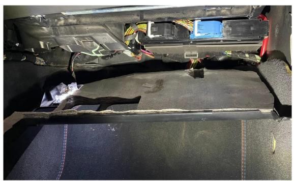
Der Stecker der Fußraumbeleuchtung muss nicht zwangsläufig entfernt werden, es reicht die Verkleidung zu lösen und in den Fußraum zu legen.
