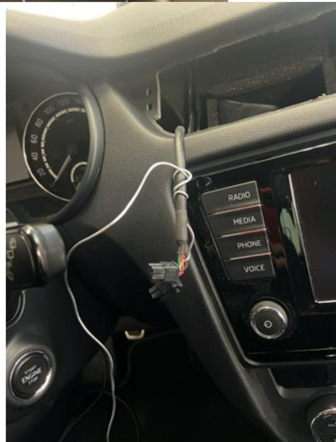
Die Lüftungsdüse einsetzen und das Kabel hindurchfädeln. Nicht das USB Kabel vergessen. Dieses ebenso hindurchfädeln und an einer Stelle verstauen, die du später wieder erreichst (z.B. im Fahrerfußraum)
